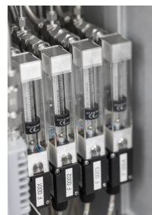
DK 800 转子流量计 用于监测进气流量
